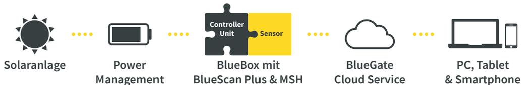
Der BlueBox Controller ist das Herzstück der Konfiguration der Messstationen. Dieser sammelt alle Messdaten und stellt diese über das integrierte Modem im BlueGate Cloud-Daten-Service zur Verfügung.
