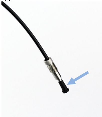
4. Lösen Sie die Inbusschrauben des Optikdeckels.
